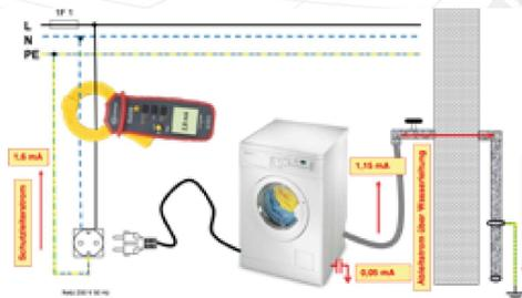
Der gesamte Geräteableitstrom wird mit dem Differenzstromverfahren über die Netzzuleitung des Gerätes gemessen. Differenzstrommessung als zusätzliche Maßnahme zur Isolationsprüfung.
