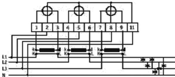
Strom wird vom Messwandlerzähler gemessen und der angezeigte Energieverbrauch muss mit dem Übersetzungsverhältnis des Wandlers, dem Wandlerfaktor, multipliziert werden.
